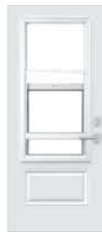
23 x 49 verre Lowe Guillotine élévation
