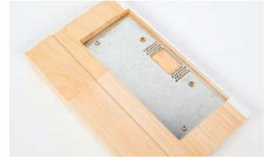
La plaque de renfort installée à l'arrière du cadre de porte côté poignée vient sécuriser le pêne dormant (barrure). La plaque de métal a pour dimension 4" x 8 11/16" x 1/16" d'épaisseur.
