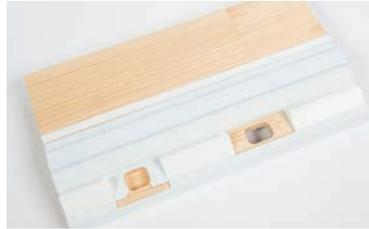
Le cadre (bâti) du côté poignée est machiné afin de recevoir les deux gâches qui permettent le passage des deux pènes.
